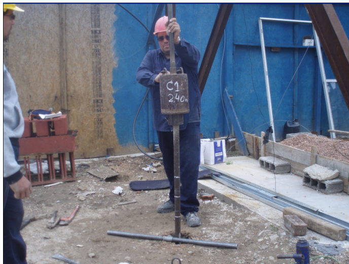
MUESTRAEDOR DE "TERZAGHI" EN PUNTA ROCA CRISTALINA FRACTURADA
