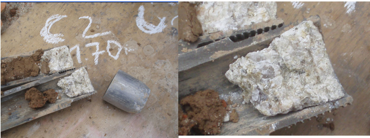
EN PUNTA MUESTRAEDOR, ROCA CRISTALINA ALTERADA
