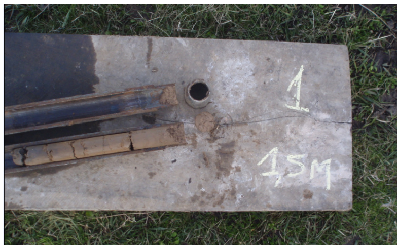
MUESTREADOR DE "TERZAGHI" ARCILLA DE COLOR MARRÓN PLASTICA
