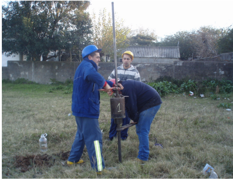
MUESTREADOR DE "TERZAGHI" ARCILLA DE COLOR MARRÓN PLASTICA
