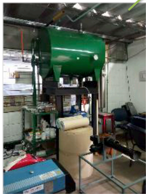
TANQUE DE AGUA Se sustituye deposito de agua por nuevo en acero inoxidable AISI 304 cap. aprox. 400 lts,
